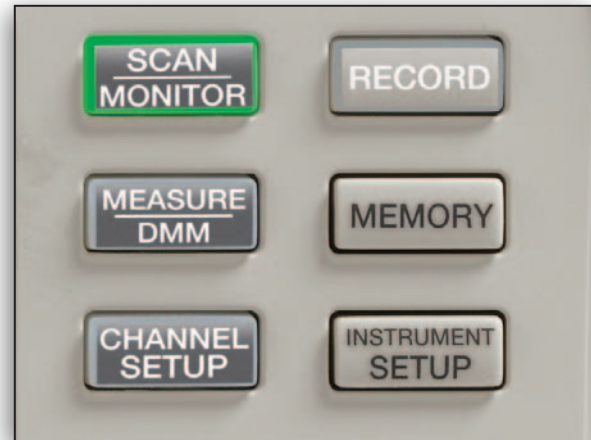
Teclas de função DMM, medição, monitoramento e varredura no painel frontal.
